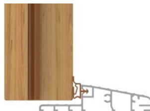
próg z uszczelnieniem
